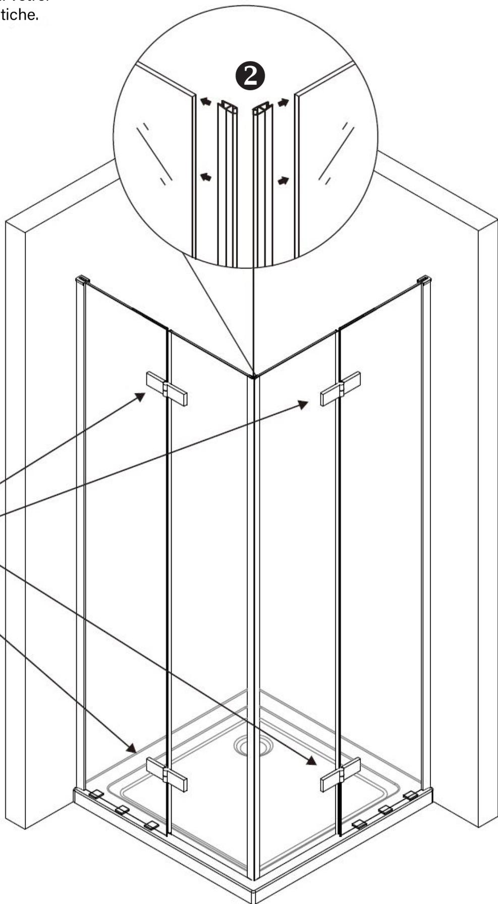
1. Allineando gli elementi in vetro nei profili terminali, è possibile ottenere un movimento regolare delle porte e della serratura magnetica.
